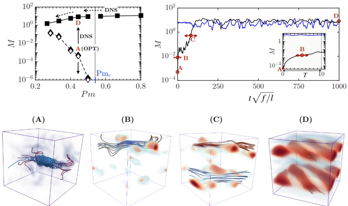
Diagramme de bifurcation (gauche): plot des graines minimal (lozange vide), qui atteignent la branche sous-critique. (droite) plot de l'énergie magnétique le long de la simulation ( positionnement des différentes visualisation 3D (A,B,C,D)). Visualisation 3D du champ magnétique ou de l'énergie magnétique (A,B,C,D): A la graine minimale est un vortex magnétique ( visualisation des lignes de champs de B et de J; D est la visualisation de l'énergie magnétique finale dans la phase de saturation.
